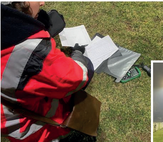
Vérification de la puissance d'éclairage, 198 LUX au sol, soit 25% de plus, mais les projecteurs sont neufs et donc exempts de poussières.
